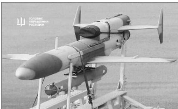
La dernière itération du drone d'attaque unidirectionnel à longue portée russe Geran est équipée d'un moteur à réaction et est apparemment envisagée pour un lancement de
